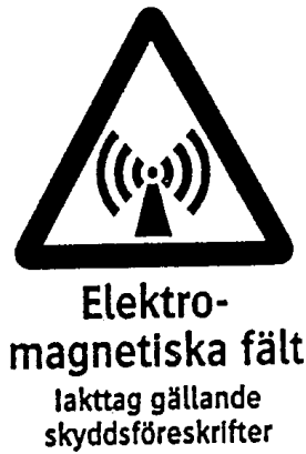
Figur 6, Varningsskylt för Elektromagnetiska fält
